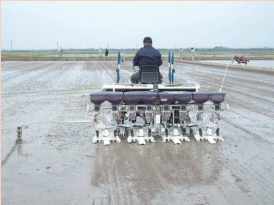
සෘජු වපුරන වගාව (වපුරන යන්ත්රයකින් සමන්විත බහුකාර්ය පැල සිටුවන යන්ත්රය ඡායාරූප කෘෂිකාර්මික කටයුතු පිළිබඳ අත්පොතෙන් අනුවර්තනය කරන ලදී
